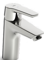
1511F Oras Swea Tvättställsblandare med Eco-top kallstartskasset. Modell XL med fast utloppspip och strålsamlare. Ecoflöde max 6l/min. Energiklass B. Inbyggd spärr för begränsning av temperatur och flöde. RSK nr: 8277742
