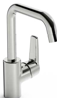
1507F Oras Swea Tvättställsblandare med Eco-top kallstartskasset. Sidospak, hög och svängbar utloppspip. Ecoflöde max 6l/min. Energiklass B. Inbyggd spärr för begränsning av temperatur och flöde. RSK nr: 8277743
