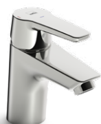
1510F Oras Swea Tvättställsblandare med Eco-top kallstartskasset. Fast utloppspip och strålsamlare. Ecoflöde max 6l/min. Energiklass B*. Inbyggd spärr för begränsning av temperatur och flöde. * Se exempel. RSK nr: 8277740
